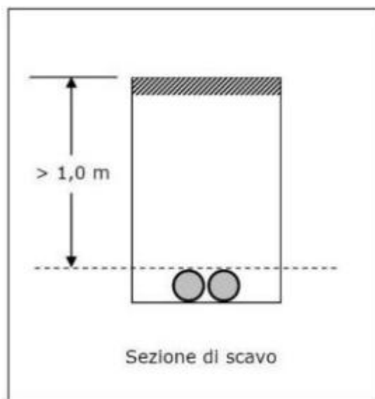
Fig. 3: sezione di scavo, da RT
