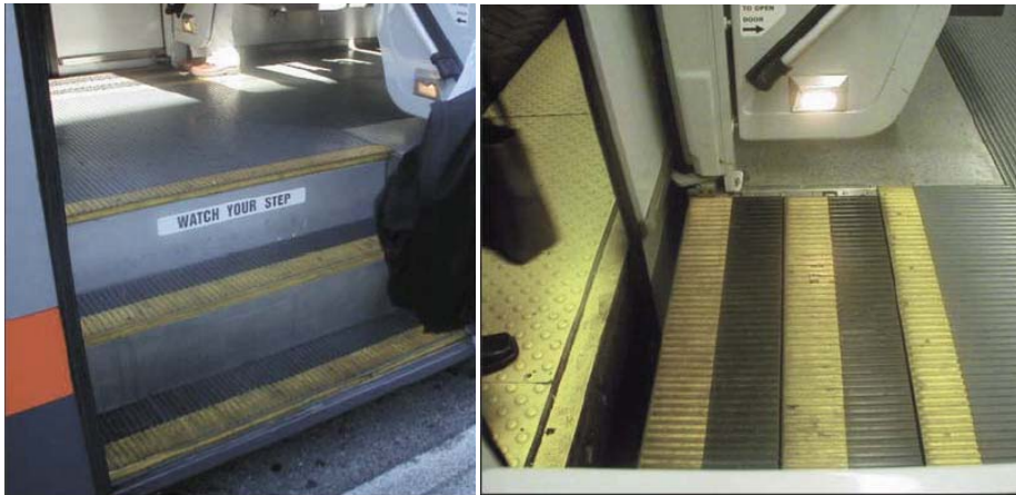
Fig. 31. Pavimento a geometria variabile in una vettura tranviaria di San Francisco, California.
