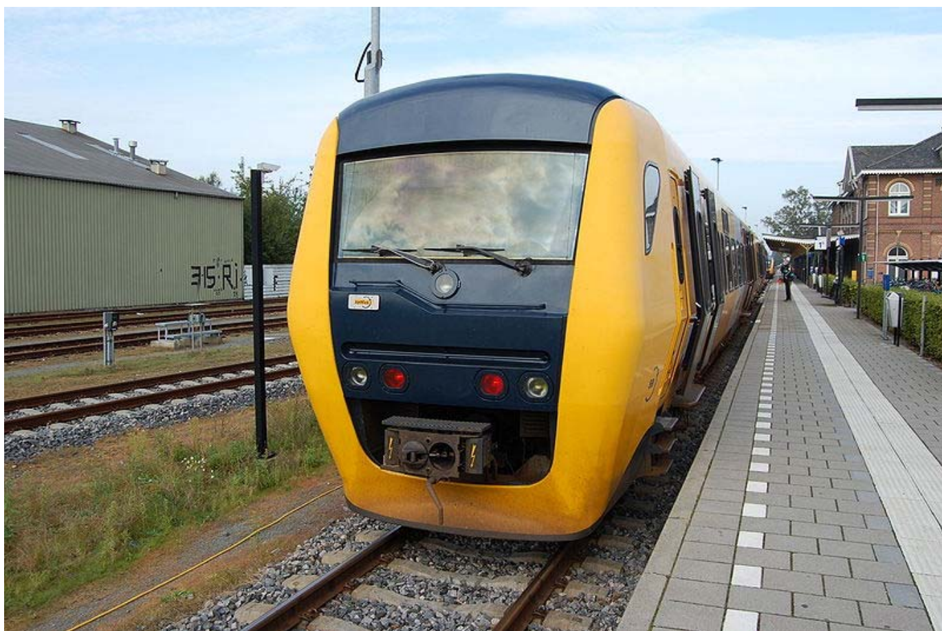
Fig. 21. Una motrice diesel Buffel , attualmente in servizio sulla linea.
