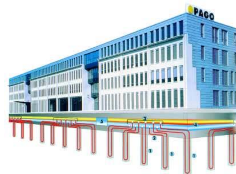
Fig. 36. 570 pali energetici sfruttano il sottosuolo situato sotto un grande complesso industriale, come fonte di calore e freddo. Per metro di palo energetico attivo, si producono, in inverno, 35 kWh di calore per il riscaldamento equipaggiato di una pompa di calore, e 40 kWh di freddo in estate per il raffreddamento di macchinari e locali (fonte: Lippuner & Partner AG, Grabs).
