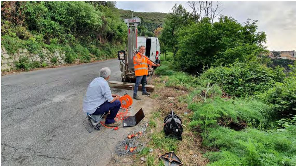
**Figura 7 - Esecuzione prova Down-Hole.**
