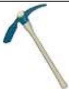
Il piccone è un arnese manuale utilizzato per spezzare i terreni duri e le rocce; serve anche per abbattere muri, pareti e altro materiale solido e massiccio. È costituito da una parte di metallo robusto (acciaio) leggermente ricurvo, terminante con due punte o con un'estremità a punta e l'altra a taglio, fissata ad un robusto manico in legno.
