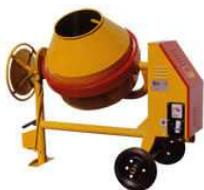
Macchina per la produzione di malte e calcestruzzi, composta da una tazza che accoglie al suo interno i componenti dell'impasto, con specifici raggi per la miscelazione. L'operazione di impasto avviene per rotazione della macchina o per rotazione dei raggi, in movimento rispetto alla macchina.
