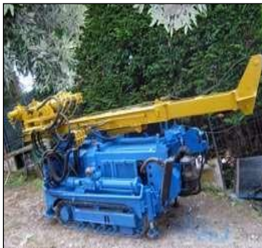
Fig. 19: Scheda tecnica della trivella CMV mod. 800 – utilizzata in situ.
