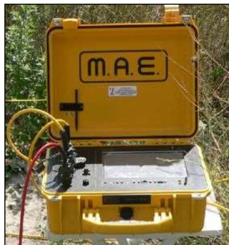
Fig. 3: sismografo multicanale M.A.E. modello A 6000 S.
