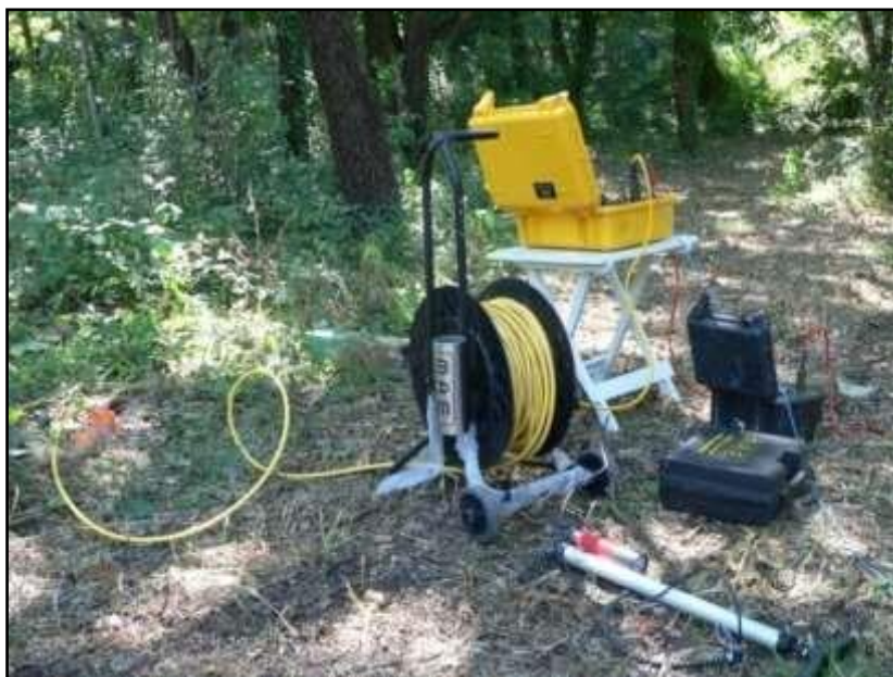
Fig. 1: sismografo multicanale M.A.E. modello A 6000 S e geofono da foro.
