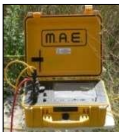
Fig. 2: sismografo multicanale M.A.E. modello A 6000 S.
