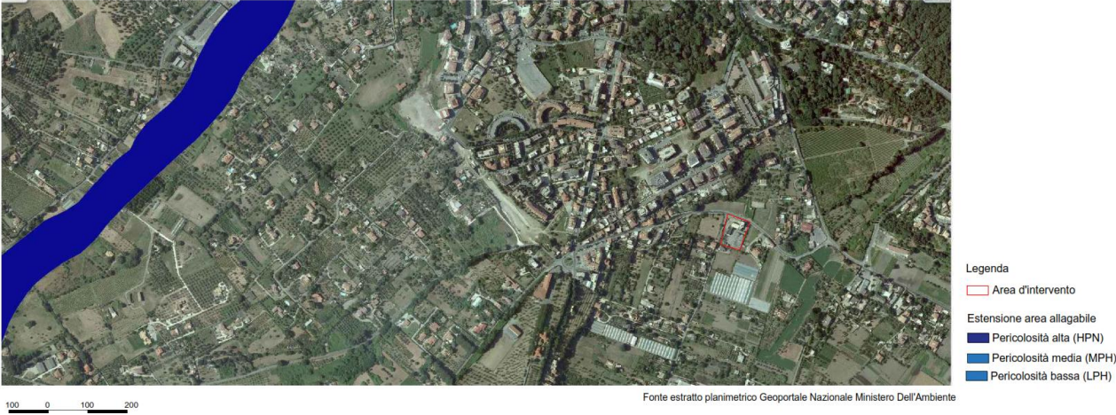
Piano di Gestione del Rischio Alluvione (PGRA 2021) - Estensione dell'area allagabile Sovrapposizione su aerofoto Scala 1:5000
