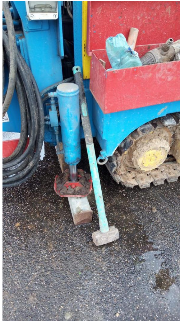
Fig. 4 – Sistema di energizzazione delle onde di taglio
