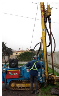
Fig. 2 – Macchina utilizzata per l'esecuzione dei sondaggi meccanici. Foto dell'esecuzione del sondaggio meccanico S2.
