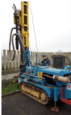
Fig. 1 – Macchina utilizzata per l'esecuzione dei sondaggi meccanici. Foto dell'esecuzione del sondaggio meccanico S1.
