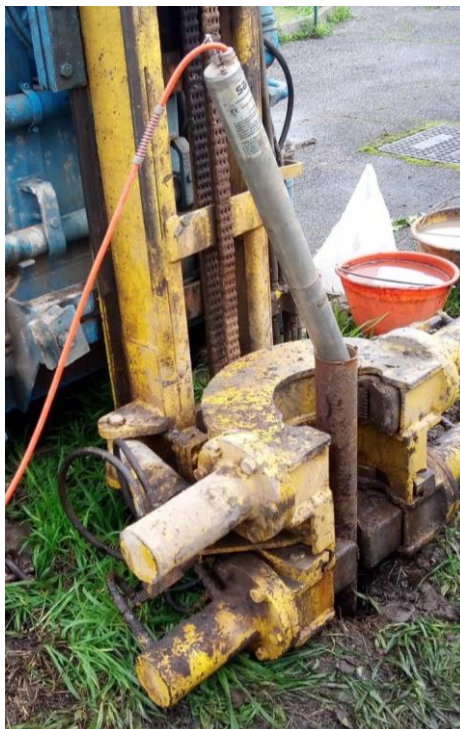
Fig. 3 – Sensore sismico quinquassiale da foro SS-BH 5C
