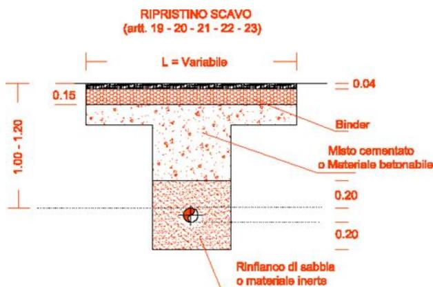
22. Il ripristino della pavimentazione sarà eseguita con cm 15 di Conglomerato bituminoso (binder) da porsi in opera entro la fine della giornata lavorativa in modo tale da rendere agibile e transitabile il tratto di strada manomesso. Lo strato di binder dovrà comprendere le fasce laterali dello scavo aventi ciascuna una larghezza di cm 40;
