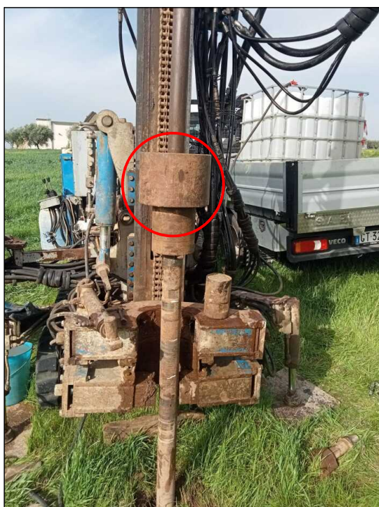
Prova S.P.T.: particolare del maglio da 63,5 kg
