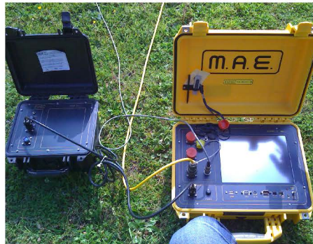
sismografo M.A.E mod. A6000S - 24 bit
