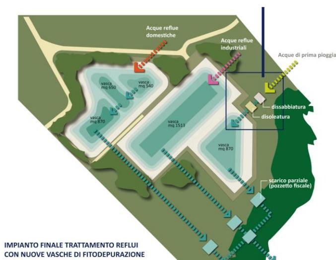
Figura 1 - Schema del nuovo sistema di gestione con "constructed wetlands" delle acque reflue
