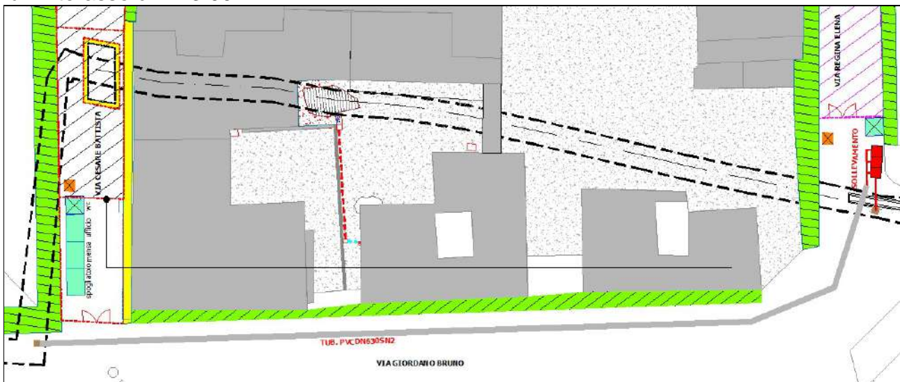
Figura 23: Tubazione provvisoria su Via Giordano Bruno
