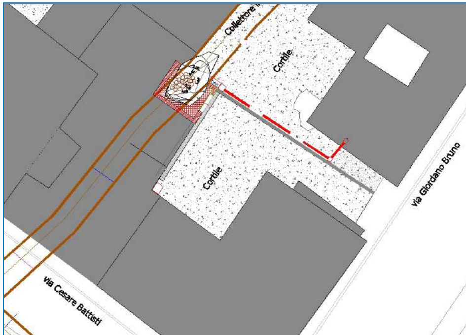
Figura 2: Percorso collettore a seguito di ispezione speleologica
