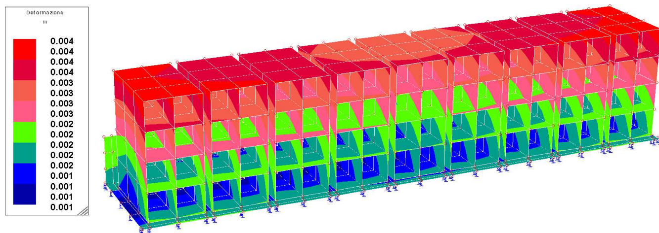
Figura 9: deformazioni allo SLV per edificio esistente ed edificio magazzino a monte
