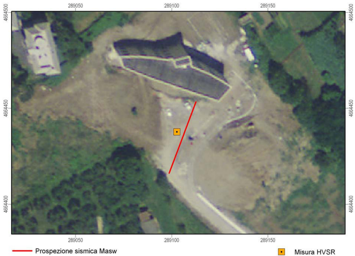
Fig. 3 – Ubicazione delle indagini geofisiche su ortofoto Sistema di coordinate UTM33 ED50
