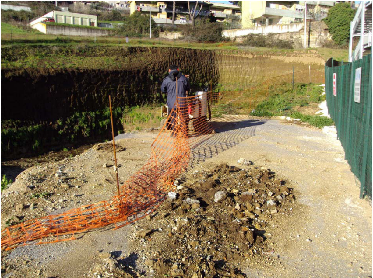
Fig. 9 – Vista del penetrometro dinamico superpesante durante l'esecuzione di una prova nell'area di studio
