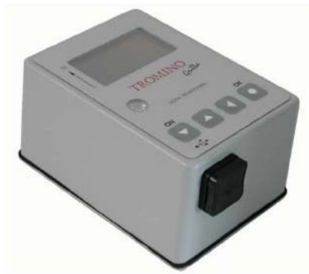
Fig. 9 - Sistema per l'Acquisizione del Rumore Sismico Tromino
