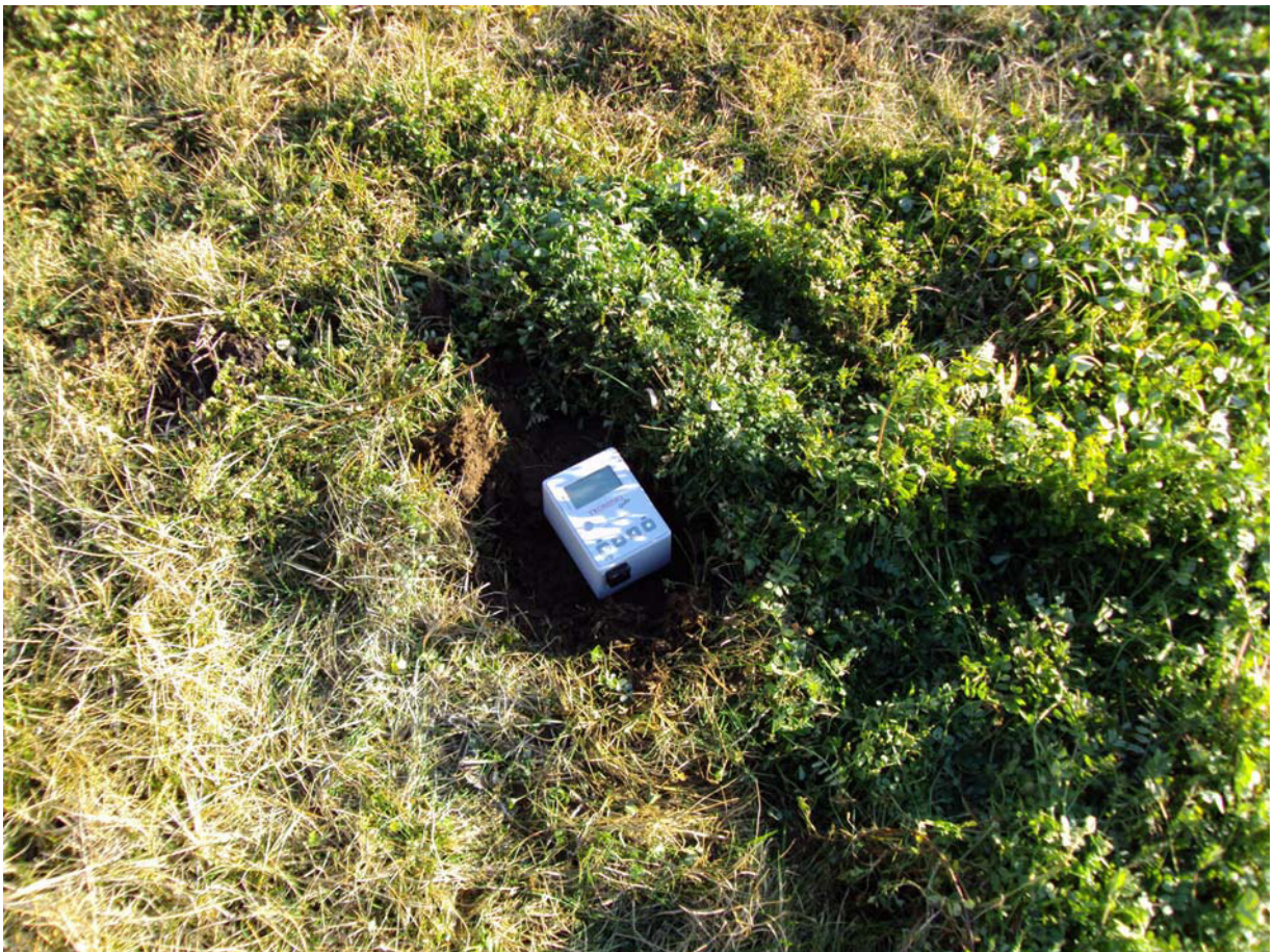
Fig. 1 - Foto della misura tromografica HVSR
