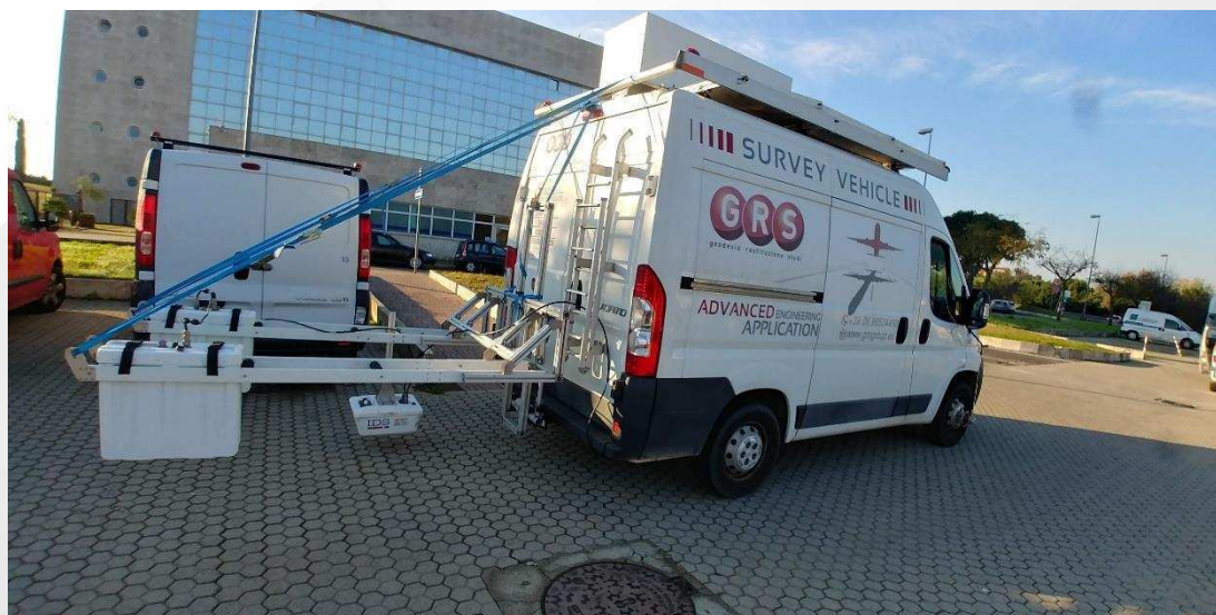
Figura 3: Sistema GPR multiantenna horn
